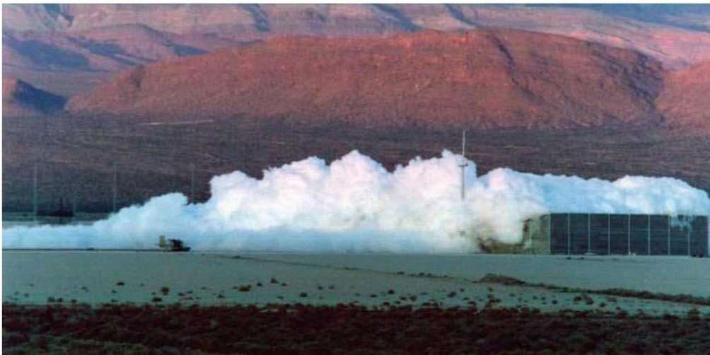
Foto 1: (Asociación española del Gas, 2012-2013) Niebla de agua generada en una prueba de derrame de GNL "Foto extraída de un trabajo de la Escuela Técnica superior de Ingenieros de minas y energía, España"
