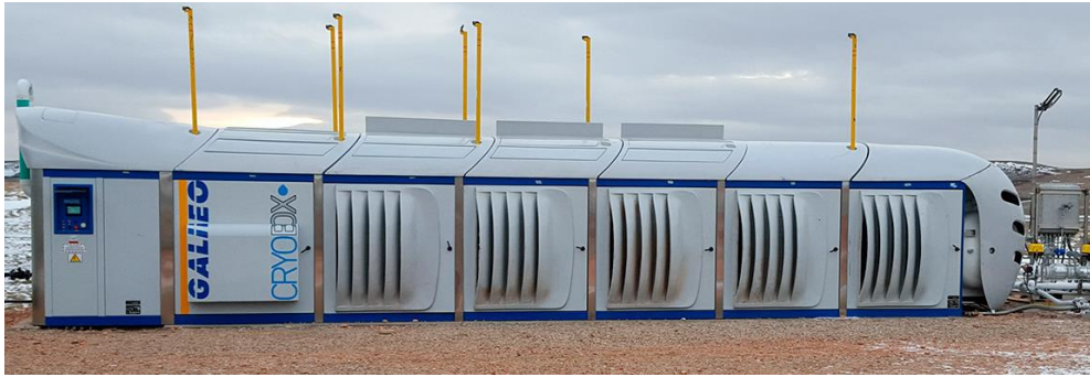
Foto 12: Estación de licuefacción Cryobox™
