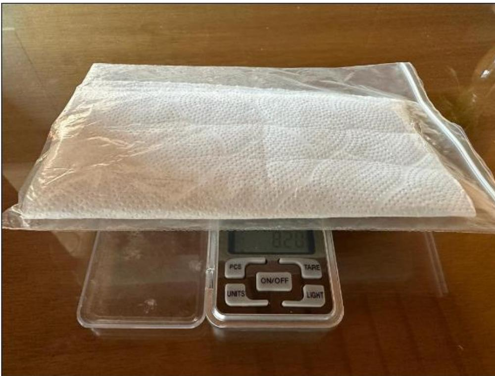
*Imagen de elaboración propia para prueba de absorción de humedad - 5 Toallas (B) secas / 0 Toallas (B) húmedas: 8,20 gr.*
