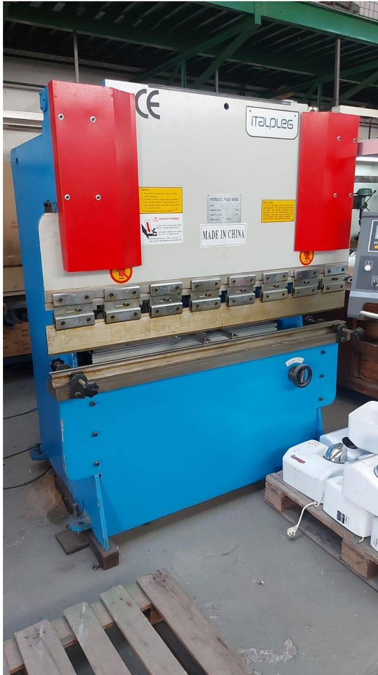
*Ilustración VII - Máquina plegadora fábrica SUPER JUMBO S.R.L*
