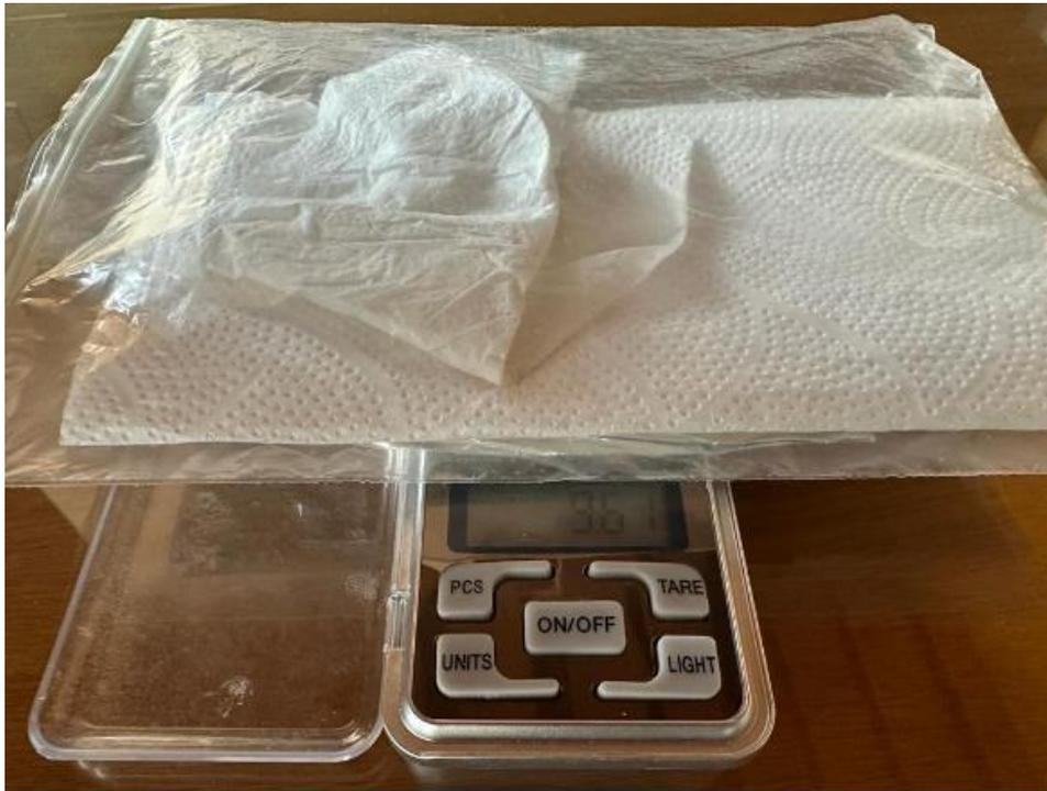
*Imagen de elaboración propia para prueba de absorción de humedad - 4 Toallas (B) secas / 1 Toallas (B) húmedas: 9,61 gr.*
