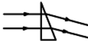
Figura 13 Tilt: el prisma corrige el tilt desviando el haz de rayos que incide en él.
