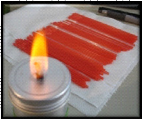
d) Sellado de pajuelas con la llama de un mechero.
