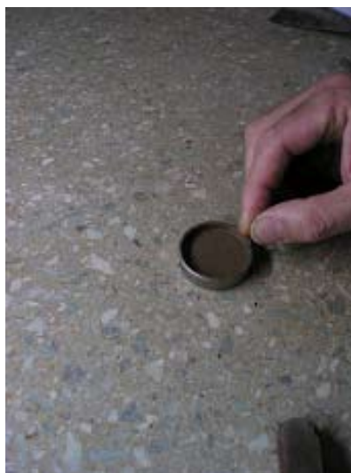
Foto 7.1.2.b: Uso de un alfiler para la eliminación de las burbujas de aire
