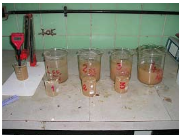
Foto 7.4.1.b: Cálculo del pH de las cuatro muestras de suelo del Nochero
