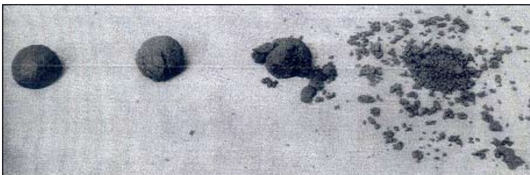
Foto 8.1.c: Fracturación de la pelota; el tercer caso desde la izquierda es el óptimo 44
