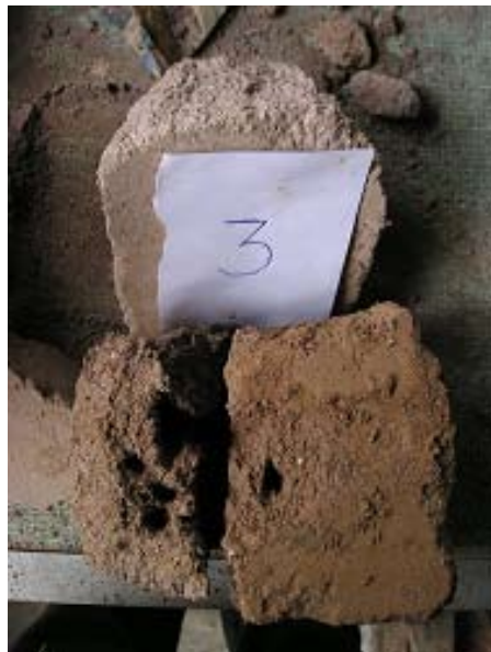
Foto b.2: Bloque n°3 después 1 minuto empezó fisurarse hasta romperse
