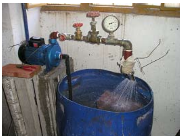
Foto 9.1.2.a: Equipo para el ensayo de erosión al agua
