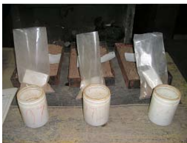
Foto 7.1.1.a: Tamizado de la muestra de suelo Foto 7.1.1.b: Muestras de suelo (suelo original, tamizado, sumergido en agua)
