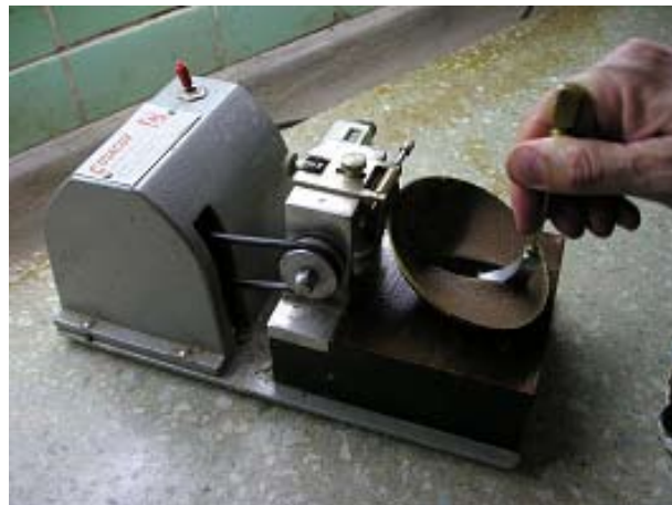
Foto 7.1.1.d: Realización del surco en la pasta de suelo
