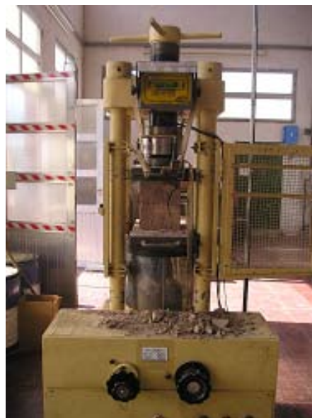
Foto 9.1.1.d: Fase de rotura de la probeta
