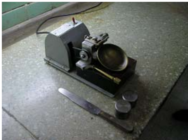
Foto 7.1.1.c: Aparato de Casagrande
