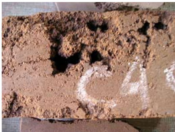
Foto a.12: Bloque C4 transcurridos 30 minutos Foto a.13: Bloque C4 al final del ensayo (transcurridos apenas 50 minutos)
