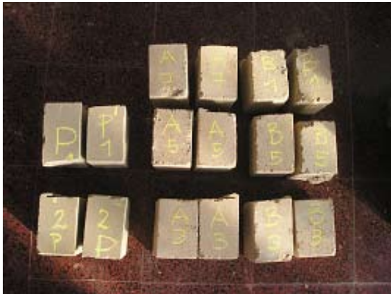
Foto 9.1.1.a: Probetas cortadas por la mitad listas para el ensayo
