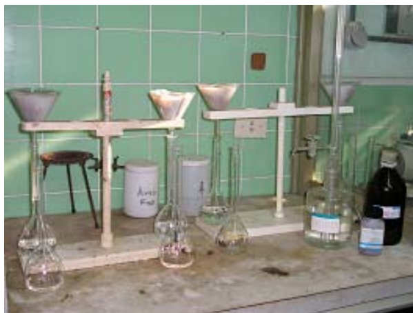
Foto 7.4.4.b: Etapa de realización del ensayo, cálculo del sodio de intercambio
