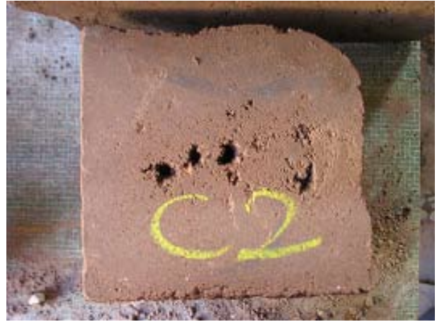
Foto a.8: Bloque C2 al final del ensayo (120 minutos)
