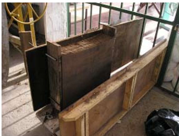
Foto 8.4.r: Tapia con cemento sacada del encofrado
