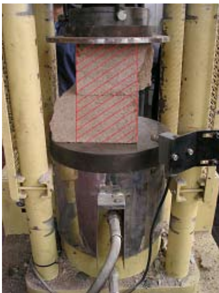
Foto 9.1.1.c: En rojo puede verse la zona de superposición de las dos partes del bloque
