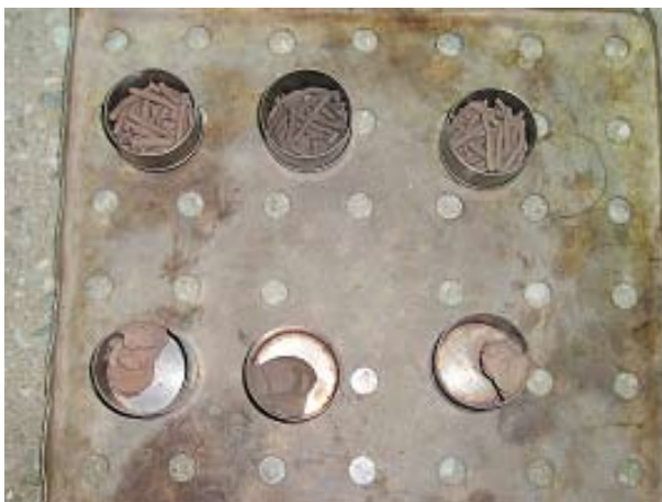
Foto 7.1.1.i: Las primeras tres muestras de suelo utilizadas para determinar el L.L. e L.P. después de haber sido secadas en estufa
