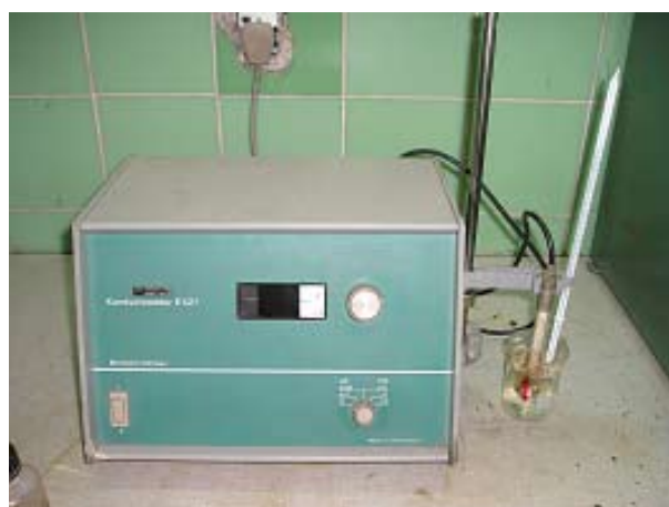
Foto 7.4.3.b: Instrumento para el cálculo de las sales solubles (conductímetro)
