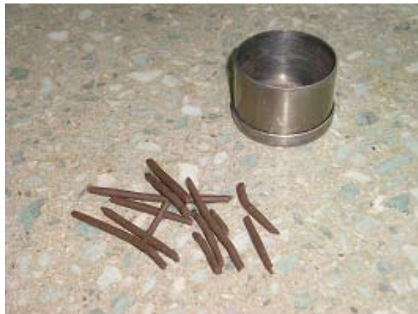
Foto 7.1.1.h: Fisuración de los bastoncitos
