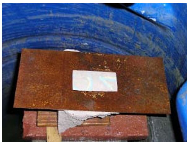
Foto 9.1.2.b: Malla para limitar el área sometida al ensayo, según Houben y Guillaud (CRATerre)
