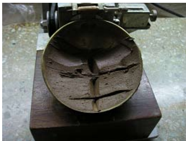
Foto 7.1.1.f: La muestra después de los 25 golpes se unió 12mm
