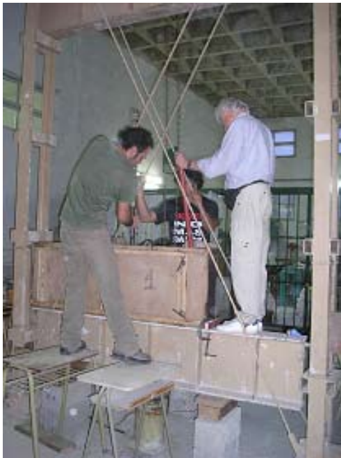
Foto 8.4.n: Realización de la tapia arriba de la prensa para el ensayo a compresión
