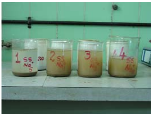
Foto 7.4.3.a: Las cuatro muestras de suelo del Nochero listas para el análisis de las sales solubles. Se nota como la muestra 1 presenta claramente la floculación.
