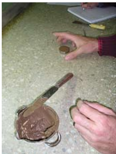
Foto 7.1.2.a: El técnico golpea la muestra con 25 golpes consecutivos de la misma intensidad
