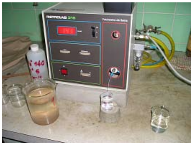
Foto 7.4.3.c: Fotómetro de llama
