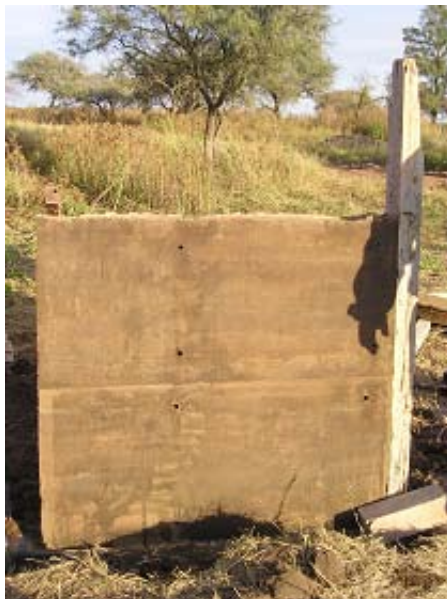
Foto 8.4.k: Prototipo de tapia estabilizada con cemento
