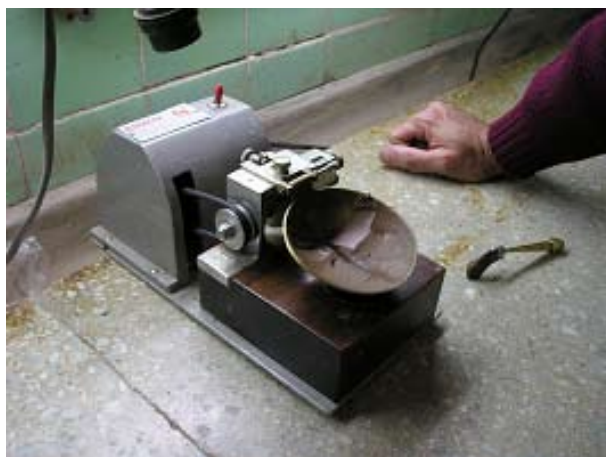
Foto 7.1.1.e: Instrumento de Casagrande en acción
