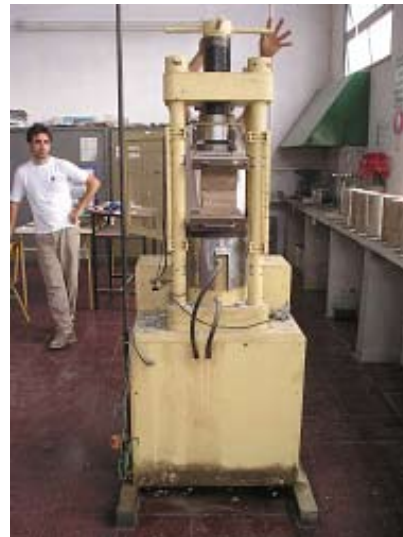
Foto 9.1.1.b: Prensa CIFIC 120 t para el ensayo de resistencia a compresión
