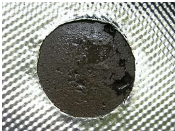
Foto c.5 – c.6: Bloque P1 terminado el ensayo (transcurridos 60 minutos)
