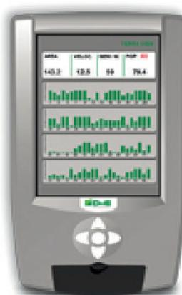
Es lo último en generación de computadoras inteligentes de siembra con pantalla color sensible al tacto de 7,8". Receptor GPS interno. Sistema basado en tecnología CAN y norma ISO BUS. Posee la capacidad de monitorear hasta 120 líneas de siembra y/o fertilizante a partir de un solo nodo. Cuenta con un sistema de alarmas sonoras y graficas por fallas totales y/o parciales (tubo tapado, falta de se-
