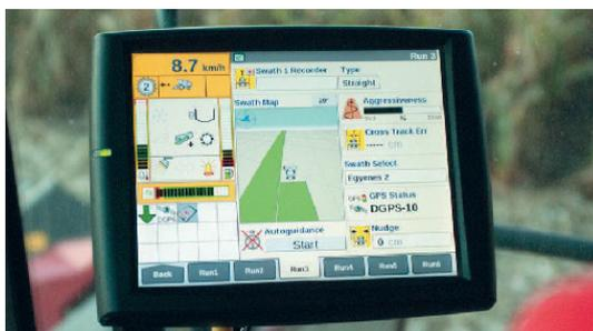
La firma Plantium ofrece el Monitor de Rendimiento S-BOX con las siguientes características pantalla táctil con un formato WIDE-SCREEN 10,2". este sistema cuenta también con antena GPS, sensor de humedad y medidor de flujo.
