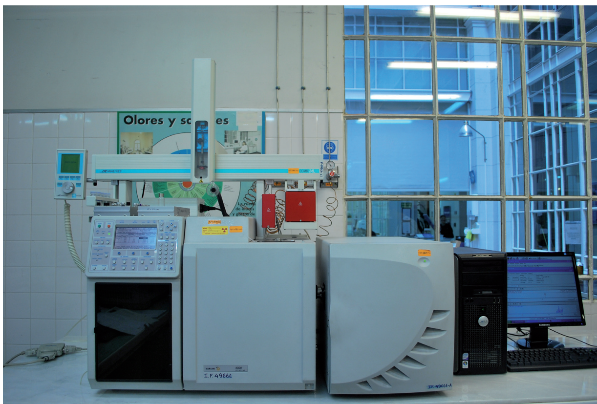
Fig. 3: Equipo utilizado para el desarrollo de este trabajo. El módulo de inyección se encuentra montado sobre del cromatógrafo gaseoso. El módulo del espectrómetro de masas se ubica a la derecha del cromatógrafo
