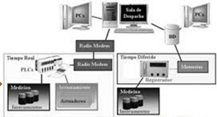
Figura 2. Recursos que involucran la adquisición y supervisión de los datos en tiempo real y diferido
