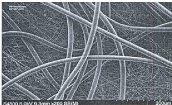
Figura 3: Micrografía electrónica de meltblown de un diámetro promedio de 250 nanómetros sobre spunbond de 20 micrones de diámetro.
