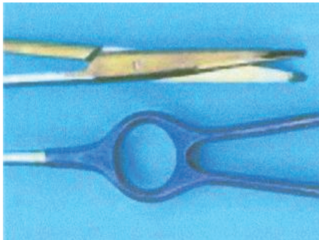
Figura 1: Instrumental quirúrgico descolorido en tono azul oscuro debido a la acción de los iones silicato.
