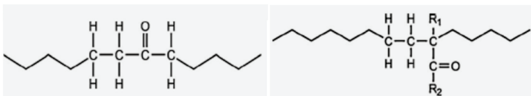
FIGURA 9: Estructuras químicas de los copolímeros etileno-monóxido de carbono (izquierda) y etileno vinil-cetona (derecha). Adoptado de Ammala et. al. [20]
