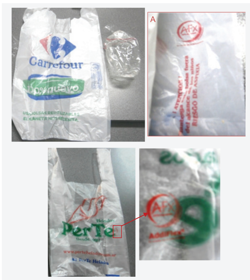
FIGURA 20: Materiales plásticos utilizados en el desarrollo experimental. A) Bolsa de polietileno de alta densidad (PEAD) con el sello de la formulación oxo-biodegradable AFX; B) Celofán de polipropileno para envasado de galletas de cereal; C) Bolsa de polietileno oxo-biodegradable
