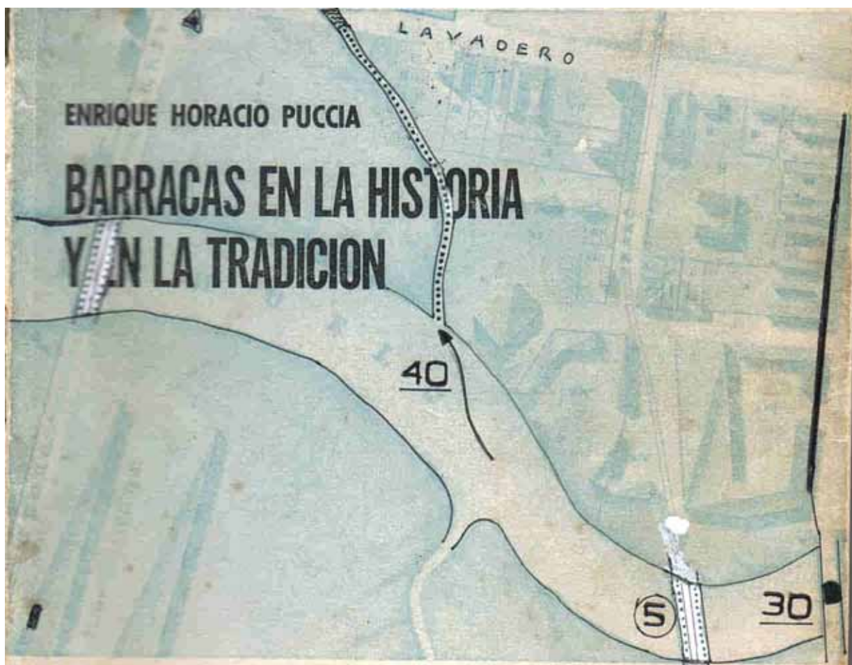
Fig.24. Sobre el mapa publicado por Puccia en la tapa de su libro de Barracas y que se corresponde con el del Catálogo Beare, se puede observar el detalle de la desembocadura del arroyo de las Pulgas. El número en círculo es la profundidad y aquellos que están subrayados pertenecen al ancho del Riachuelo. Los datos están en metros y fueron relevados por Madero en su estudio del puerto de Buenos Aires antes de su ensanchamiento y profundización.
