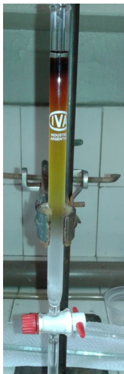
Imagen 22. Aislamiento y purificación del producto (61) mediante cromatografía de adsorción en columna
