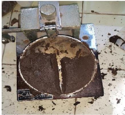
*Figura 5.2. Ensayo de límite líquido (Fuente: el autor).*
