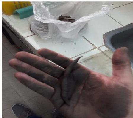
*Figura 5.3. Ensayo de Límite plástico (Fuente: el autor).*
